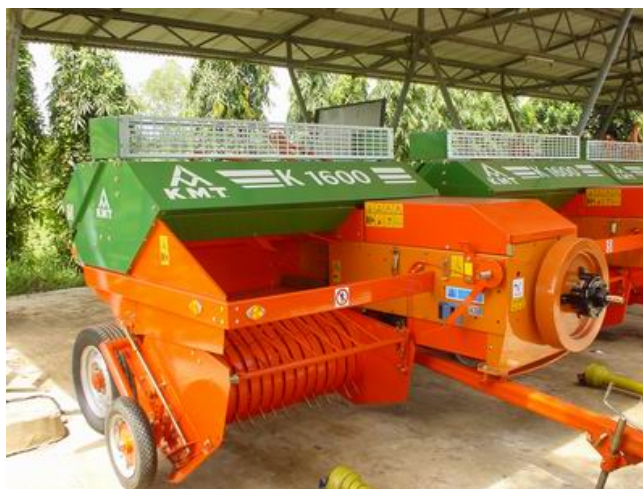
ภาพที่ 26 เครื่องอัดฟ่อนหญ้าแห้งแบบอัตโนมัติติดท้ายแทรกเตอร์
