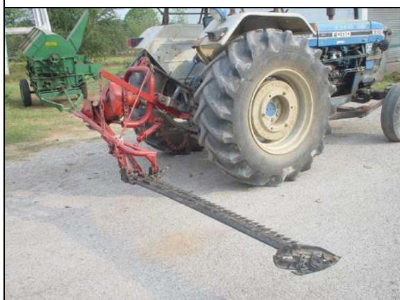
เครื่องตัดหญ้าปัดตาเถียนแบบติดท้ายแทรกเตอร์
