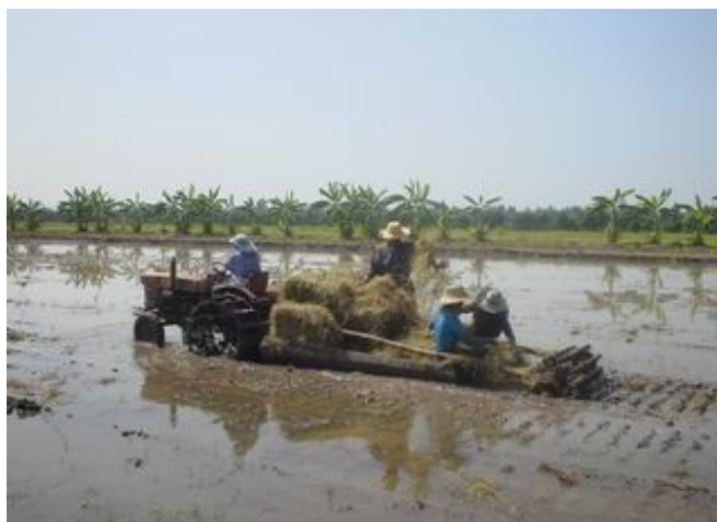
ภาพที่ 12 การหว่านท่อนพันธุ์หญ้าโดยใช้ชุดปลูกหญ้าแบบกระบะท้องแบน
