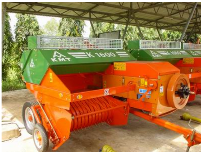
ภาพที่ 26 เครื่องอัดฟ่อนหญ้าแห้งแบบอัตโนมัติติดตั้งแทรกเตอร์
